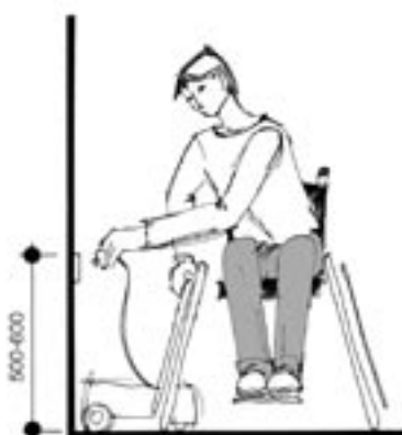
Obr. 66. Vhodné výškové umístění zásuvky.
