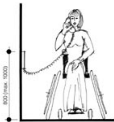
Obr. 67. Vhodné výškové umístění domácího telefonu.
