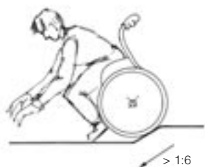
Obr. 19. Špatný sklon - nebezpečí vyklopení vozíčkáře. Při nevhodném sklonu nájezdu na chodník, větším než 1:6 hrozí při sjíždění na vozovku vyklopení vozíčkáře, který se z vozíku vysune. Při najíždění je naopak reálné nebezpečí přepadnutí s vozíkem dozadu. Bez cizí pomoci prudký nájezd vozíčkář nevyjede.
