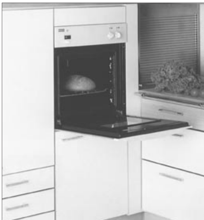
27. Vhodně umístěná pečicí trouba v kuchyni určené tělesně postižené osobě. Pečicí troubu nesmíme nikdy osadit na zem. Jde jednak o jednoduchost manipulace, jednak o bezpečnostní hledisko z hlediska manipulace s velmi horkými předměty. V dosahu pečicí trouby musíme vždy počítat s místem na odložení předmětu, který z trouby vyndáváme. I zde rozhoduje, zda je klient levák či pravák. (Zdroj: katalog firmy Villeroy & Boch.)
